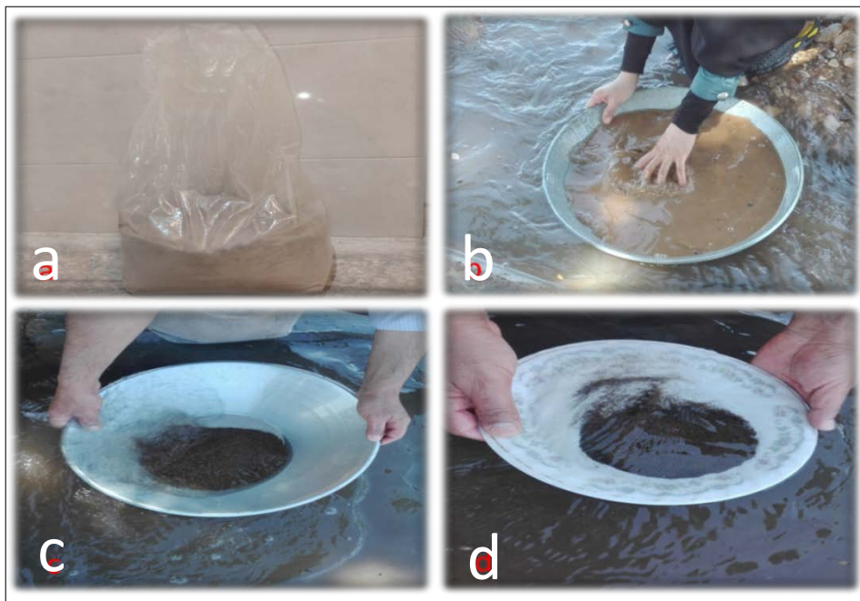
شکل ۳-۱۳- مراحل چندگانه گل‌شویی و لاوک‌شویی نمونه‌های کانی سنگین.
