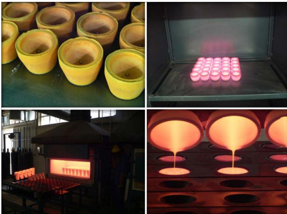
شکل ۳-۴- مراحل آماده‌سازی نمونه‌های ژئوشیمی رسوب آبراهه‌ای برای عیارسنجی طلا در تکنیک غال‌گذاری.
