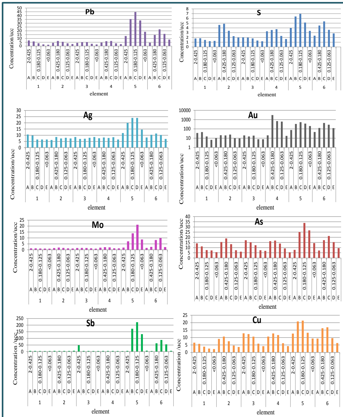
شکل ۳-۹- نمودار ستونی توزیع عناصر S و Mo, Sb, Pb, Cu, As, Au, Ag در جزء مش‌های مختلف ۶ نمونه نمونه رسوب آبراه‌ای.
