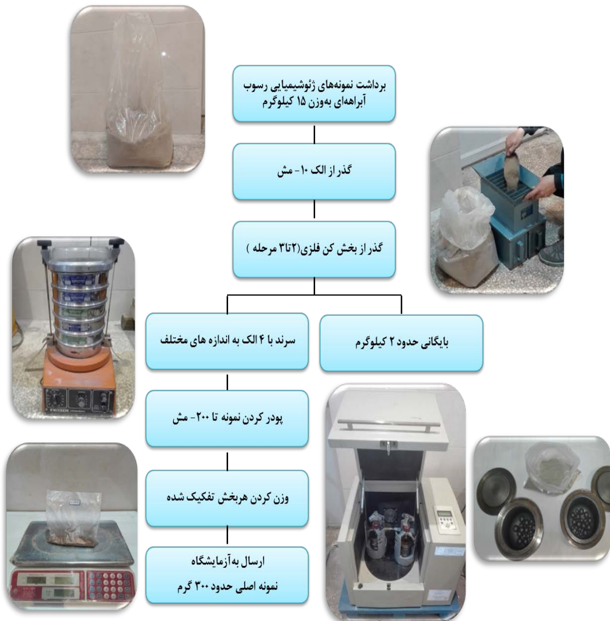
شکل ۳-۳- نمودار جریان‌ی تجزیه سرنده‌ی نمونه‌های ژئوشیمی رسوب آبراهه‌ای و انتخاب نمونه معرف هر جزء برای تجزیه شیمیایی.
