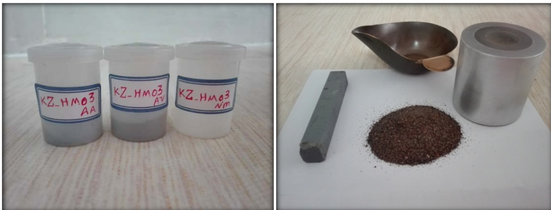
شکل ۳-۱۵- جدایش مغناطیسی بخش سنگین نمونه‌ها با استفاده از آهنرباهای ویژه.
