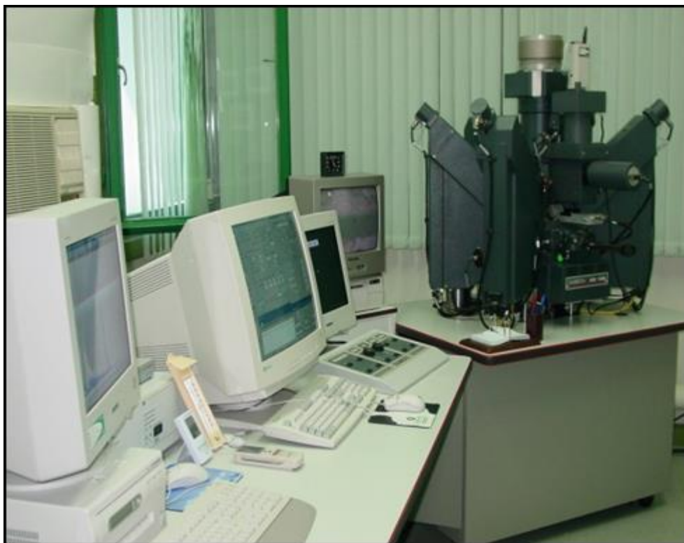
شکل ۴-۱- تصویر دستگاه EMPA مرکز تحقیقات فرآوری مواد معدنی ایران بخش کانی شناسی.
