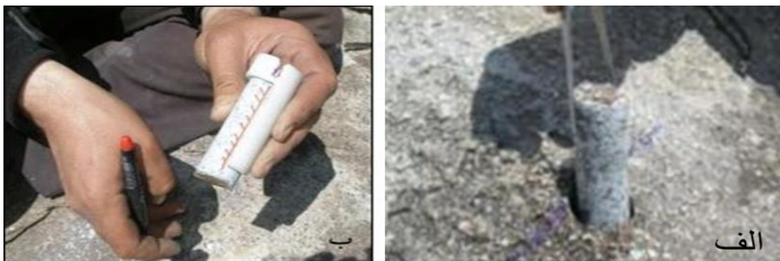
شکل ۵-۷- الف) نحوه خارج ساختن مغزه از زمین بعد از مشخص کردن شیب و جهت شیب ب- نحوه استفاده از نیم لوله پلاستیکی برای هاشور زدن مغزه.
