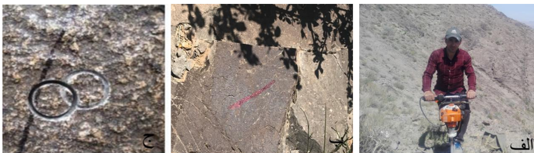
شکل ۵-۵-الف دستگاه مغزه‌گیر. ب خط راهنما. ج خط راهنما و محل حفاری مغزه
