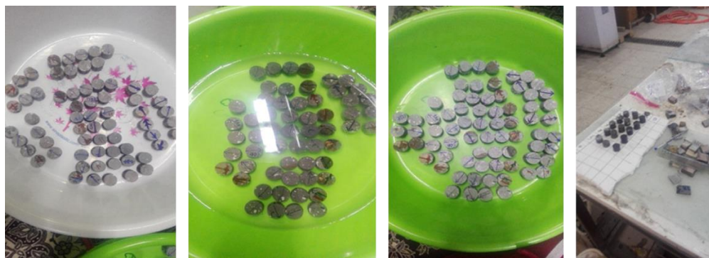
شکل ۵-۸- نحوه برش و آماده سازی نمونه‌ها. بعد از برش جهت شیب هر مغزه بر روی کلیه قطعات تهیه شده ترسیم می‌گردد.
