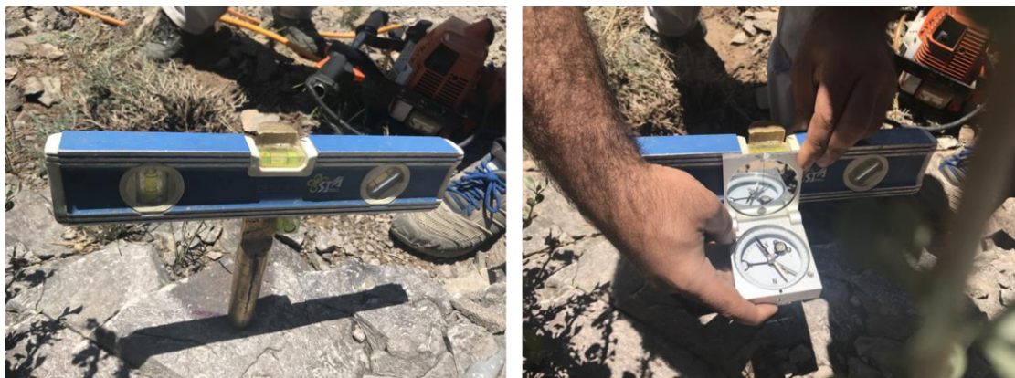
شکل ۵-۶- در این تصاویر نحوه برداشت شیب و جهت شیب، توسط کمپاس و تراز یاب مغزه نشان داده شده است.
