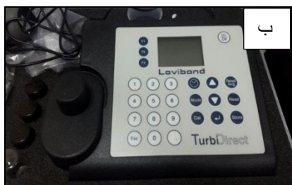
شکل ۳-۳: الف) دستگاه نورسنج شعله ای. ب) دستگاه کدورت سنج. ج) دستگاه کروماتوگرافی یونی مورد استفاده برای آنالیز نمونه‌ها
