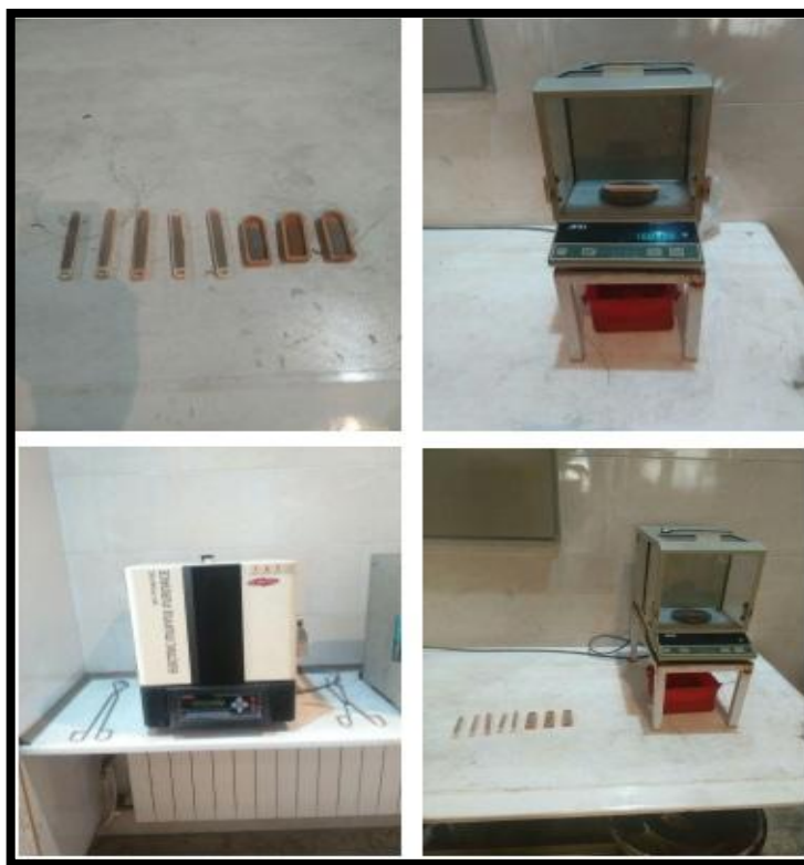
شکل (۳-۳): نمایی از آزمایش تعیین (LOI) در آزمایشگاه
