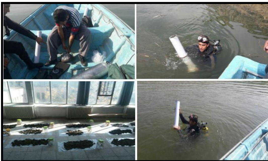
شکل (۲-۳) نمایی از روش نمونه برداری از رسوب و آماده سازی آنها در آزمایشگاه
