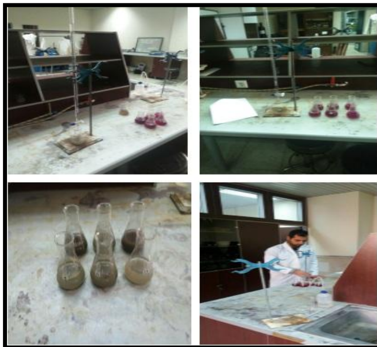
شکل (۳-۴) آزمایش اندازه‌گیری درصد کربنات کلسیم نمونه‌ها در آزمایشگاه
