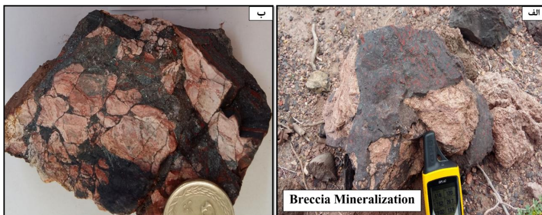
شکل ۴-۵: الف و ب) تصاویر صحرایی و نمونه دستی از کانه‌زایی برشی در منطقه.
