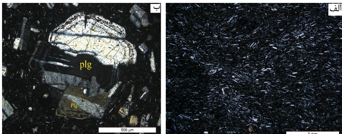
شکل ۳-۸- تصویر یک نمونه بازالتی غنی از پلاژیوکلاز که در نتیجه ردیف شدن میکروولیت‌ها منجر به بافت جریانی شده است. ب) تصویری از درشت بلورهای پلاژیوکلاز با منطقه‌بندی در سنگ‌های بازالتی منطقه. هر دو تصویر در نور XPL.
