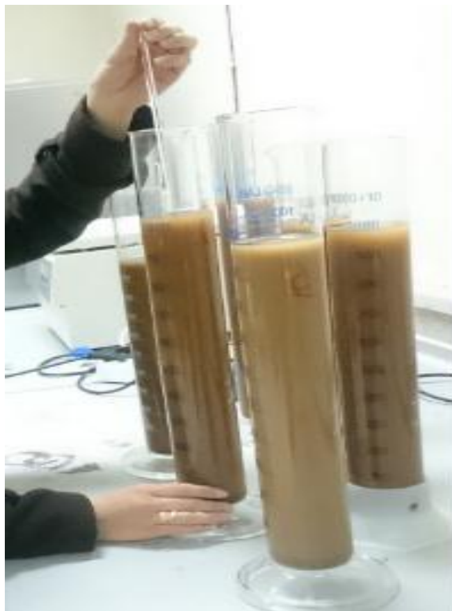
شکل ۳-۴- اندازه‌گیری بافت باطله‌های فرآوری
