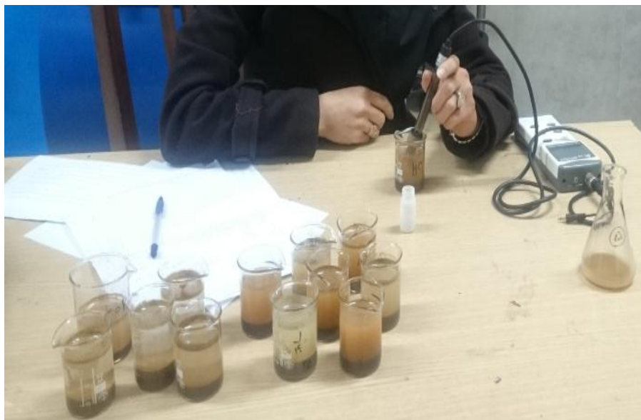
شکل ۳-۲: اندازه‌گیری pH باطله‌های فرآوری در آزمایشگاه
