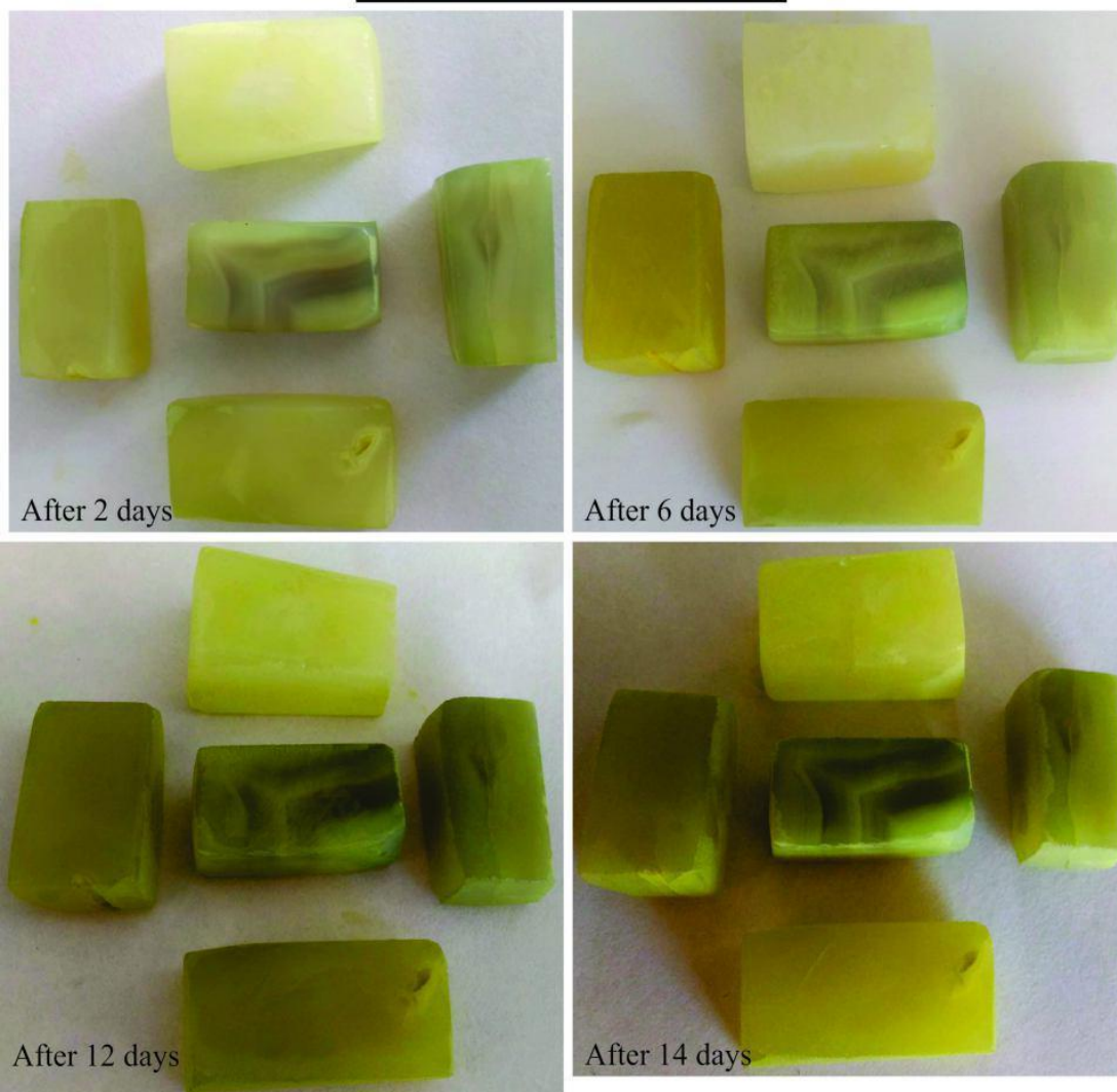
شکل ۳-۵- نمونه های قرار داده شده در محلول نیکل نیترات هگزا هیدرات در دمای 70^{\circ}\text{C} .
