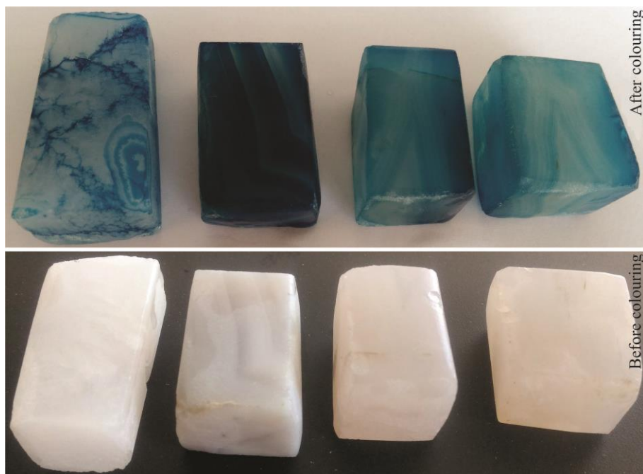
شکل ۳-۱۰- نمونه های قرار گرفته در پتاسیم فری سیانید- سولفات آهن در دمای 50^{\circ}\text{C} بعد از گذشت یک هفته.
