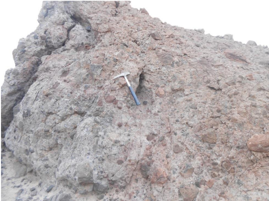
شکل ۲-۱۶- نمایی از آگلومراهای موجود در منطقه با قطعات زاویه دار با ابعاد چند میلی متر تا چند سانتیمتر که دارای گسترش زیادی در منطقه می‌باشند.
