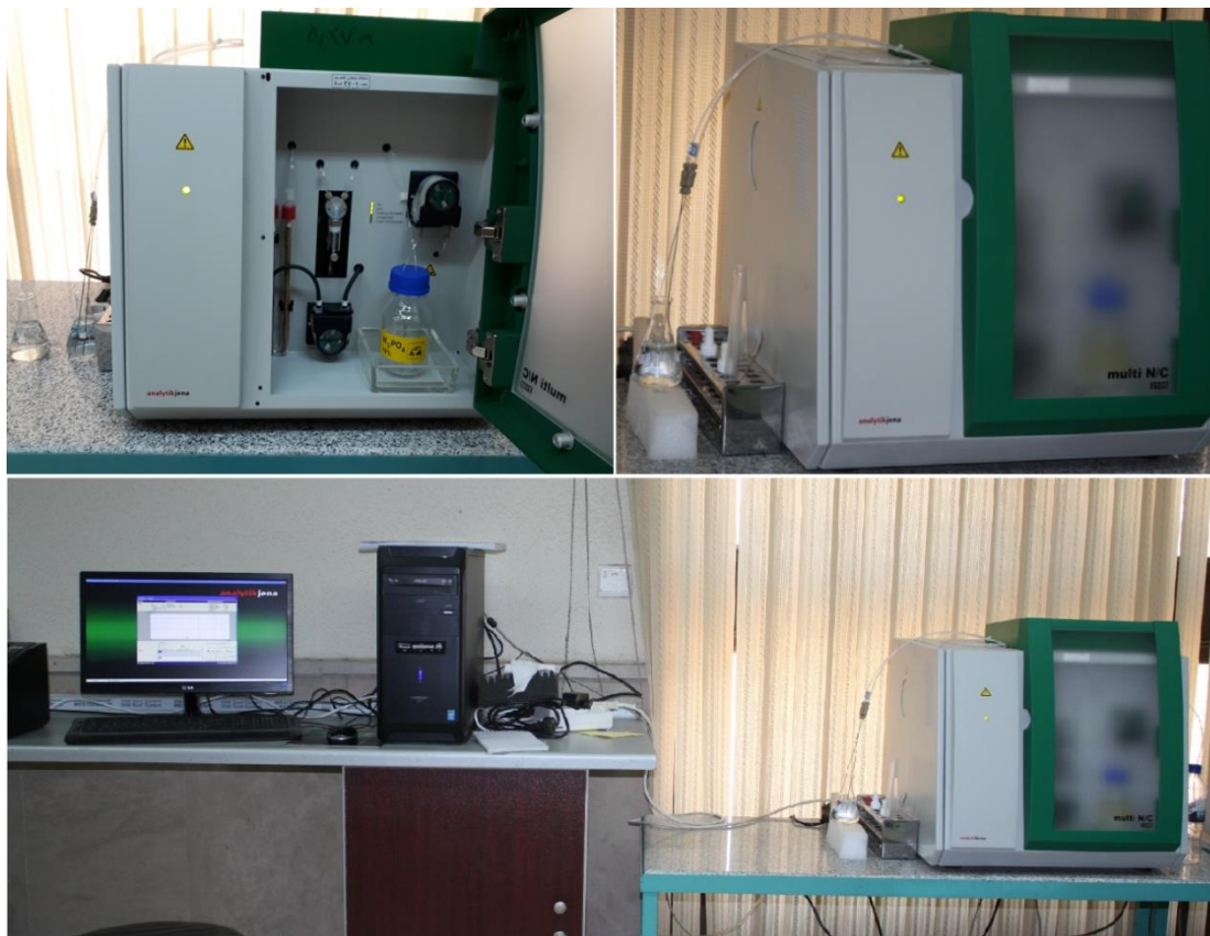
شکل ۳-۶- دستگاه آنالیز کننده کربن آلی کل (بالا) ومانیتور نشان دهنده ثبت کننده اطلاعات (پایین)
