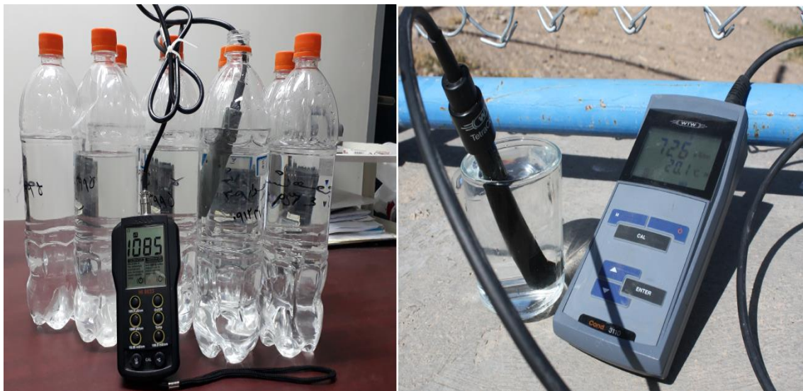
شکل ۳-۵- اندازه‌گیری هدایت الکتریکی در محل نمونه‌برداری و آزمایشگاه
