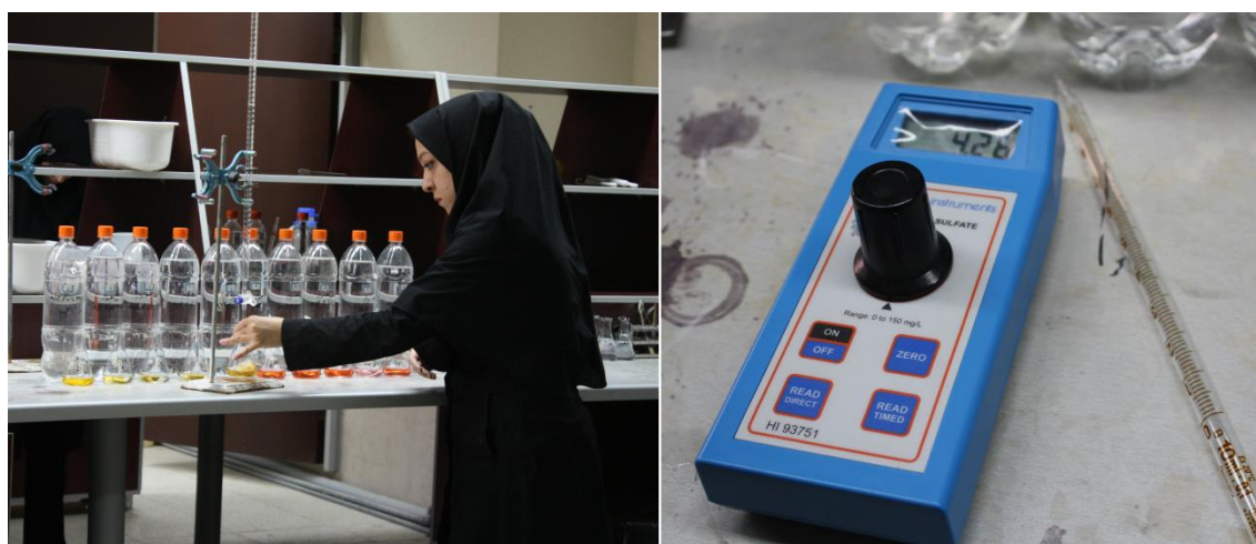
شکل ۳-۴- روش توربیدیتی متری (راست) و روش تیتراسیون (چپ) جهت اندازه‌گیری یون‌های اصلی در آب
