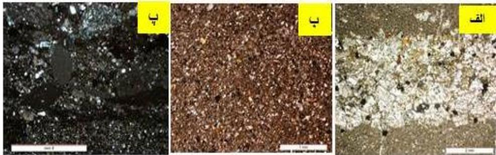
شکل ۳-۱۲- تصویر میکروسکوپی از ماسه سنگ توفی خاکستری با لامینه های تشکیل دهنده آن: الف) میکروکنگلومرا، ب) توف آندزیتی، پ) لیتیک کریستال توف، ت) گلسنگ آهکی توفی
