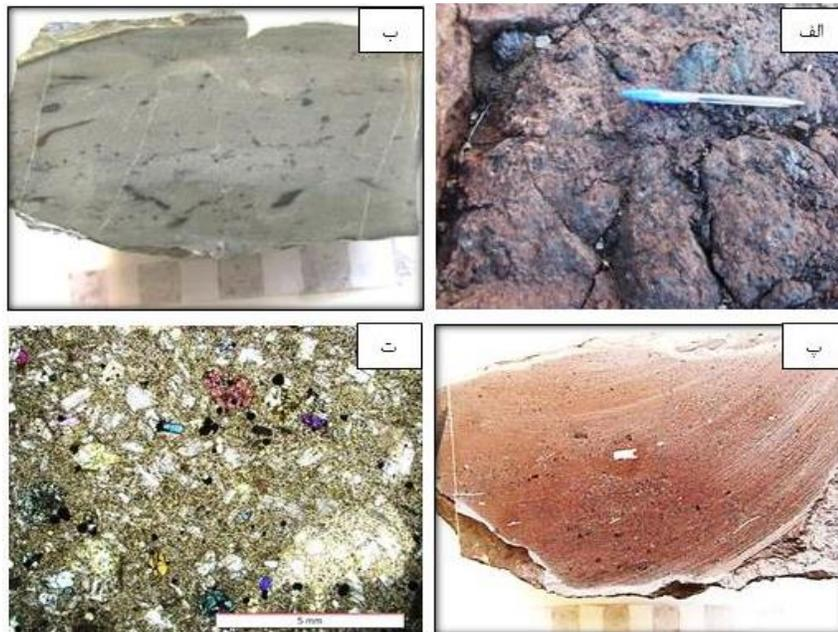
شکل ۵-۲-الف) رخنمونی از ساخت دانه پراکنده که اکسیدهای منگنز در داخل سنگ میزبان آهکی به صورت پراکنده و جانشین فسیلها شده است. ب) نمونه دستی از این بافت در سنگ آهک ماسه ای کمربالا شکل پ و ت) نمونه دستی از توف با بافت دانه پراکنده و تصویر میکروسکوپی آن
