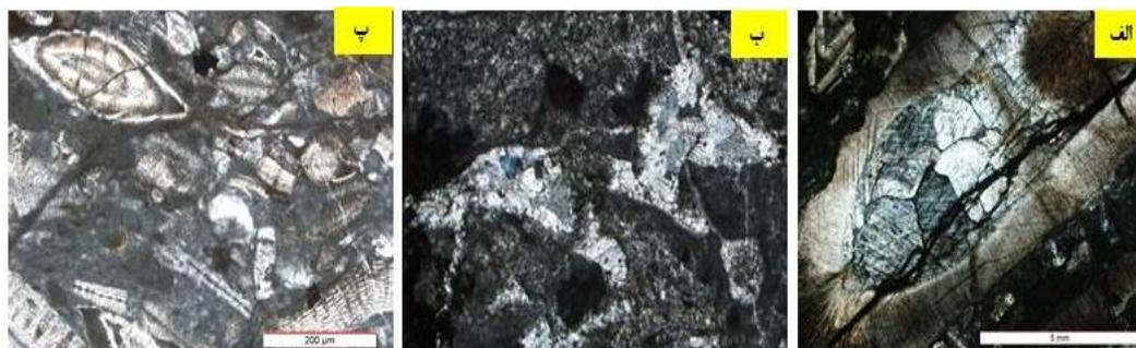
شکل ۳-۹- الف و ب) سیمان کلسیت اسپاری پرکننده حفرات فسیلها و شکستگیها و پ) میکرایت پرکننده فضای بین دانه ها و درون فسیلها
