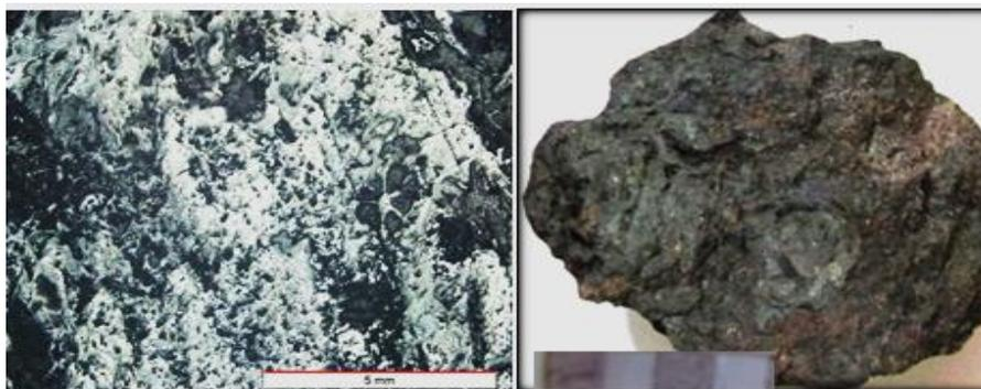
شکل ۴-۵- نمایی از بافت کانسنگ توده‌ای: الف) در مقیاس نمونه دستی ب) تصویر میکروسکوپی از این نمونه که غنی از
