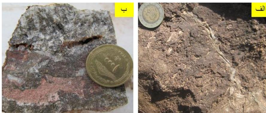
شکل ۵-۱۱-الف وب) نمایی از رگه سیلیسی-کربناته از بخش رگه-رگچه ای کانسار در مقیاس رخنمون و نمونه دستی
