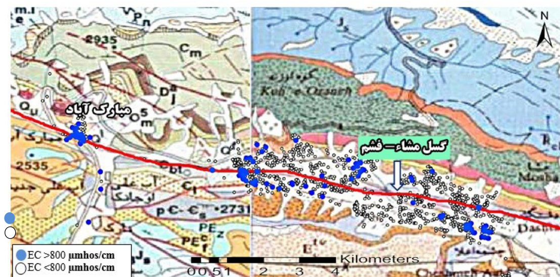
شکل ۴-۱۵- محدوده گسل مشا- فشم و چاه‌های مشخص شده با مقدار هدایت الکتریکی بیش‌تر و کم‌تر از میانگین
