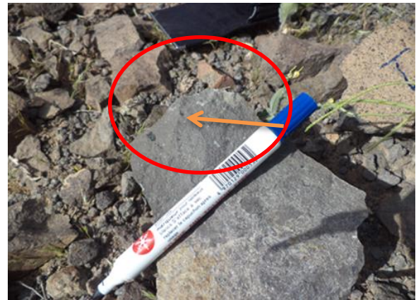
شکل ۲-۸- تصویری از یک نمونه دستی سنگ داسیتی و آنکلاو موجود در سنگ داسیت
