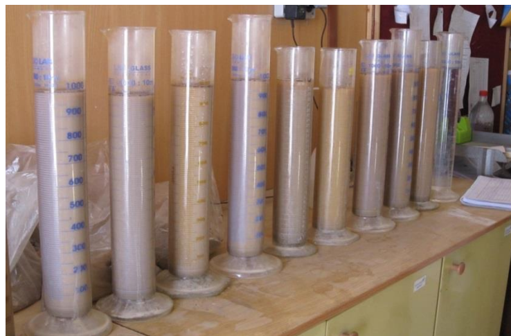
شکل ۳-۳- اندازه‌گیری بافت خاک به روش هیدرومتری
