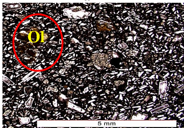
شکل ۳-۲۶- تصویر میکروسکوپی نشان‌دهنده اولیوین بولنژیته شده. فنوکریست‌های ریز پلاژیوکلاز و پیروکسن فراوان در متن سنگ حضور دارند (نور PPL).
