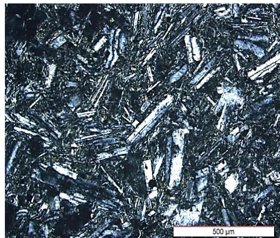
شکل ۳-۱۳- بافت پورفیری و گلوپورفیری (حاصل تجمع بلورهای پلاژیوکلاز) در داسیت (نور XPL).
