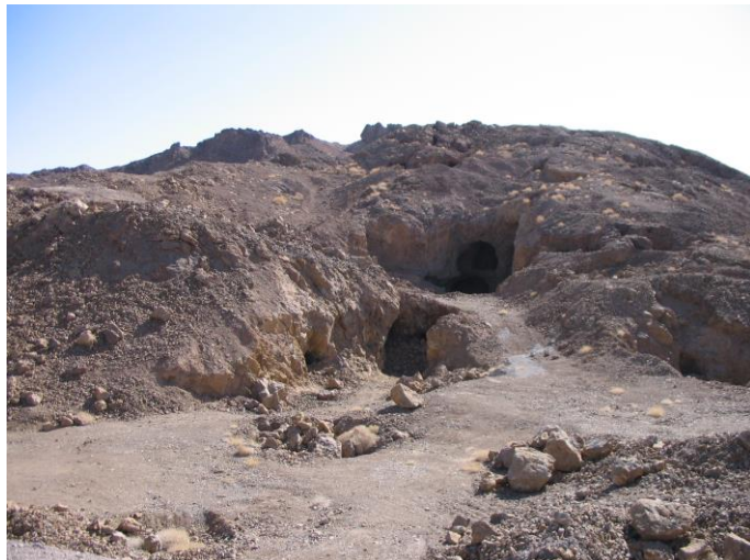
شکل ۲-۲۰- نمایی از تونل‌های حفر شده جهت استخراج کنسارهای سرب و روی واقع در شمال آبادی سوسنوار.
