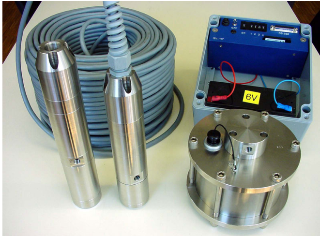
شکل ۱-۲ - فلوریمترهای صحرایی برای آشکار سازی ردیاب در آب سطحی (سمت راست) و زیرزمینی (سمت چپ)
