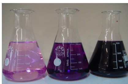
شکل ۳-۵- محلول پرمنگنات پتاسیم از غلظت 1000 تا 10 میلی‌گرم بر لیتر
