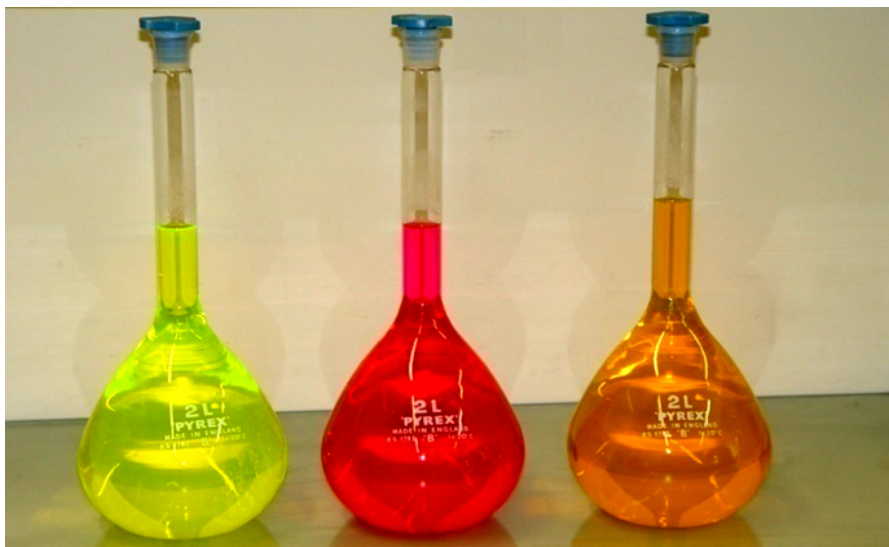
شکل ۳-۴ - محلول‌های مادر ائوزین، رودامین B و اورانین، با غلظت ۱۰ میلی‌گرم بر لیتر به ترتیب از راست به چپ
