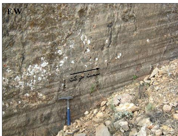
شکل ۴-۴۲- نمایش خراش‌های گسلی افقی بر روی سطح گسل غرب آبشار (دید عکس به سمت جنوب).
