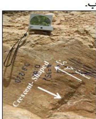
شکل ۳-۱۰-الف- نمایش بلوک دیاگرام شکستگی‌های برشی نوع R (Fossen, 2010)، ب- تصویر صحرایی از اشکال هلالی شکل (Crescent-Shaped).
