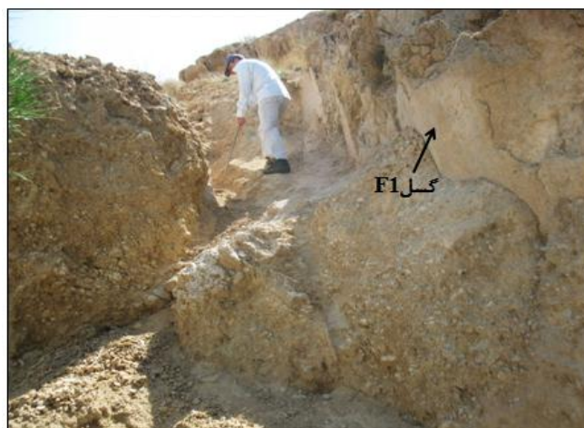
شکل ۴-۲۵-الف- نمایی از گسل F1 در مرز بین واحدهای مزوزوئیک و دشت جلالی با موقعیت میانگین N48^{\circ}E/78^{\circ}SE (دید عکس به سمت شمال خاور)، ب- خردشدگی (برشی شدن) آهک همراه با سطح گسل F1 (دید عکس به سمت شمال خاور).
