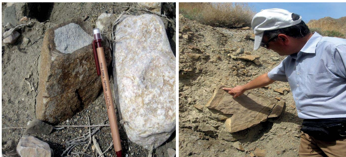
شکل ۲-۲۶- دگرسان شدید ماسه‌سنگ‌هاى سازند شمشک
