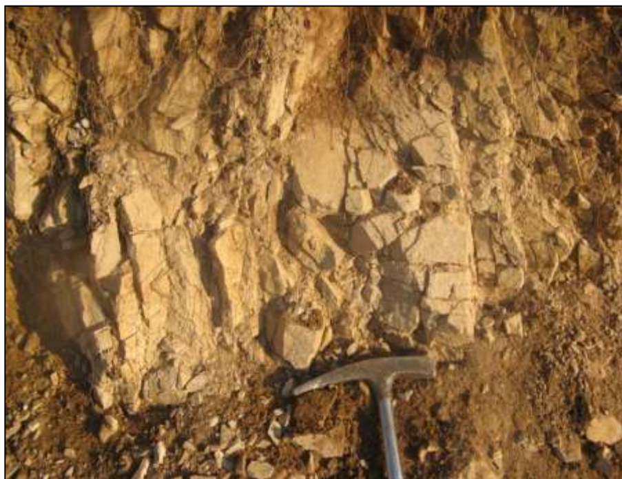
شکل ۲-۹- نمایی از توده دیوریتی دگرسان که در آن به سختی درشت‌بلورهای پلاژیوکلاز و پیروکسن قابل مشاهده‌اند.
