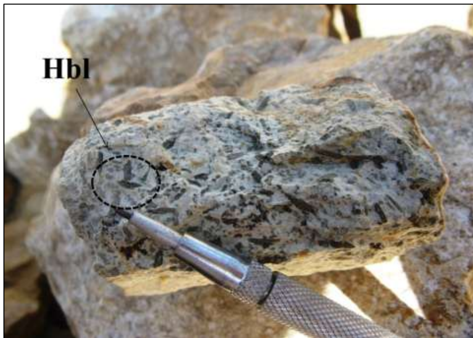
شکل ۲-۱۴- تصویری از نمونه دستی دایک که در آن درشت بلورهای منشوری هورنبلند به خوبی قابل مشاهده‌اند.
