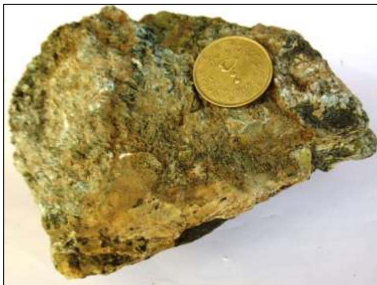
شکل ۴-۱۹- تصویری از نمونه دستی فلوگوپیت اسکارن که از ورقه‌های سبز فلوگوپیت تشکیل شده و به صورت متراکم بر روی هم قرار گرفته‌اند.
