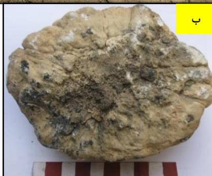
شکل ۴-۸-الف- نمایی از رخساره کانسنگ لایه‌ای که از پهنه استرینگر دور است و میزان سلسیت بالایی دارد. ب- نمونه دستی سلسیت شکل(الف)
