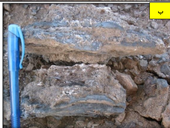
شکل ۴-۷- الف نمایی از رخساره کانسنگ لایه‌ای را نشان می‌دهد. ب- نمونه دستی از همان پهنه که نزدیک پهنه استرینگر می‌باشد و میزان منگنز بالایی دارد.
