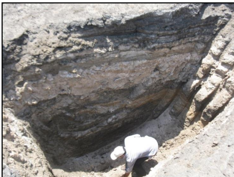
شکل ۴-۹- حفاری‌هایی که جهت اکتشاف در رخساره لایه‌ای ایجاد شده است. در این عکس نوارهای روشن تناوبی از مارن، ژپس و سلسیت می‌باشند و نوارهای سیاه منگنز را نشان می‌دهد.
