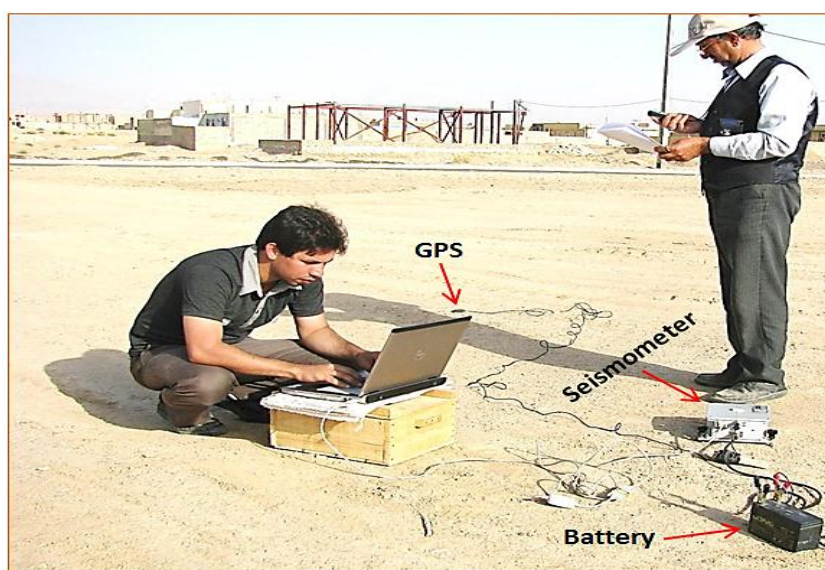
شکل ۴-۱۶- قرار دادن دستگاه برداشت داده‌های میکروترمور بر روی سطح خاکی سفت- شهرک رضوان شهر
