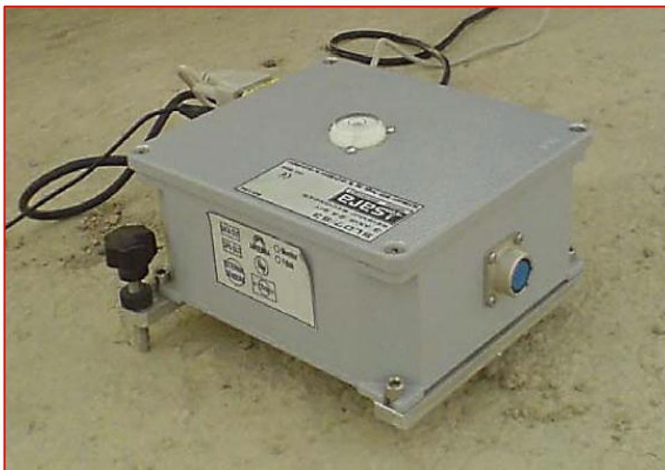
شکل ۴-۱۷) - دستگاه لرزه‌نگار سه کاناله SL07 ساخت شرکت SARA ایتالیا
