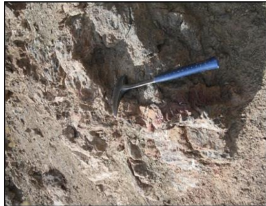
شکل ۲-۱۰- تصویری از سنگ‌های لیستونیتی که در اثر واکنش با سیالات سیلیسی- کربناته به وجود آمده‌اند (شمال شرق روستای اللهیار).
