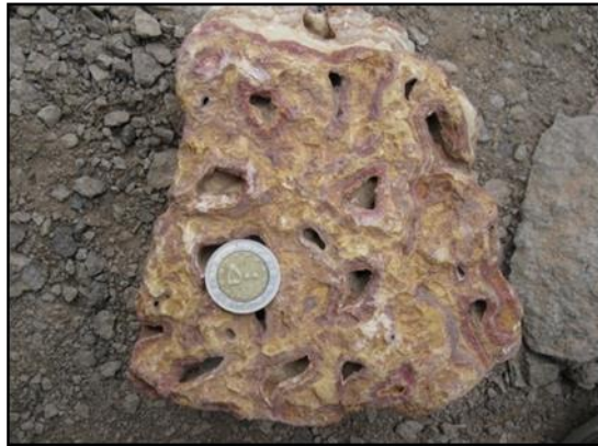
شکل ۲-۵۳- تصویری از رگه‌های سیلیس آمورف آغشته به آهن تشکیل شده در زون‌های گسلی (شرق رونشک).
