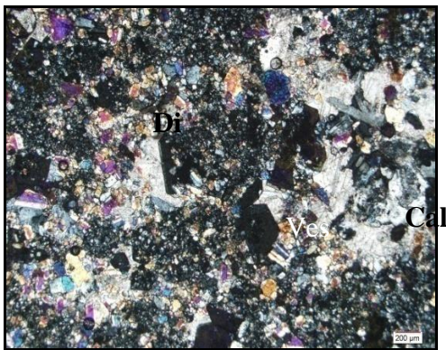
شکل ۲-۴۵- تصویر میکروسکوپی اسکارن وزوویانیت‌دار تشکیل شده در محل کنتاکت سنگ میزبان با گنبد رمی (xpl). گارنت (گروسولار) به صورت دانه‌ریز در سنگ وجود دارد.
