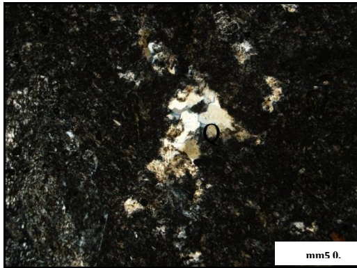
شکل ۳-۶۱- تصویر میکروسکوپی از کوارتزهای پر کننده حفره (XPL).
