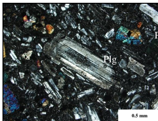
شکل ۳-۴- تصویری از بافت‌های پورفیری و جریان‌ی در تراکی - شکل ۳-۵- تصویر میکروسکوپی معرف حضور آنکلاو میکروگرانولار مافیک در سنگ‌های تراکی آندزیتی (XPL).
