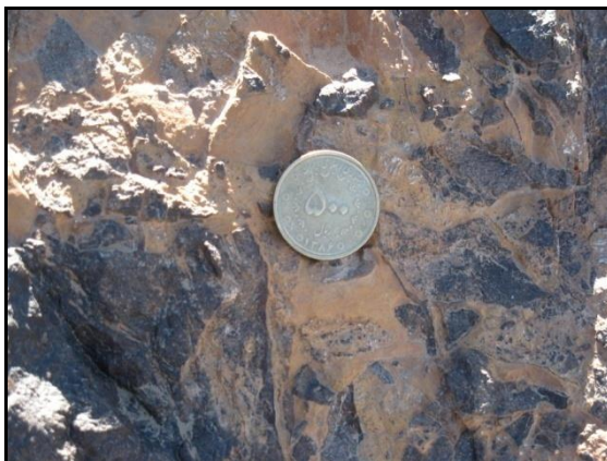
شکل ۲-۷۹- تصویر از کانه‌زایی باریت همراه با اکسید آهن در مناطق به شدت برشی شده شرق همند.
