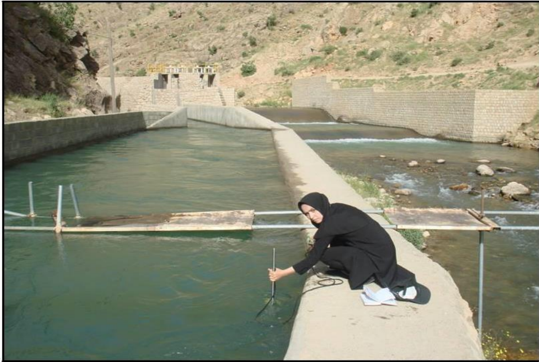
شکل ۳-۱- اندازه‌گیری دبی در کانال بتونی
