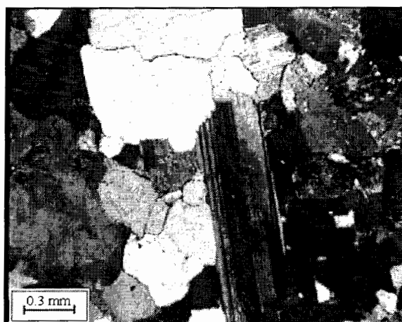
شکل ۳-۱۳- تصویر میکروسکوپی از بافت گرانولار در نمونه‌های گرانیتی منطقه مورد مطالعه، XPL
