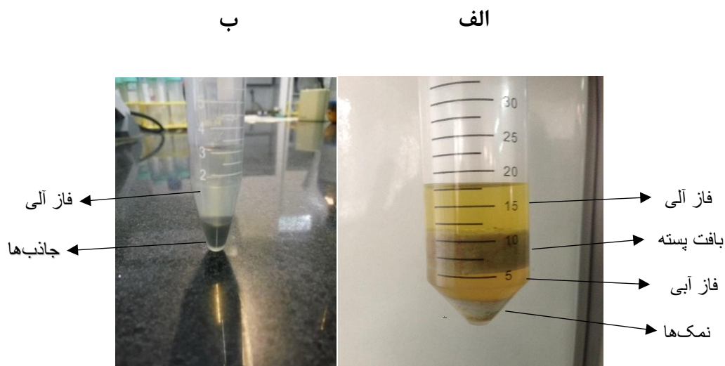
شکل ۳-۱۱ فازهای جدا شده در روش کچرز الف) پس از استخراج ب) پس از مرحله پاکسازی
