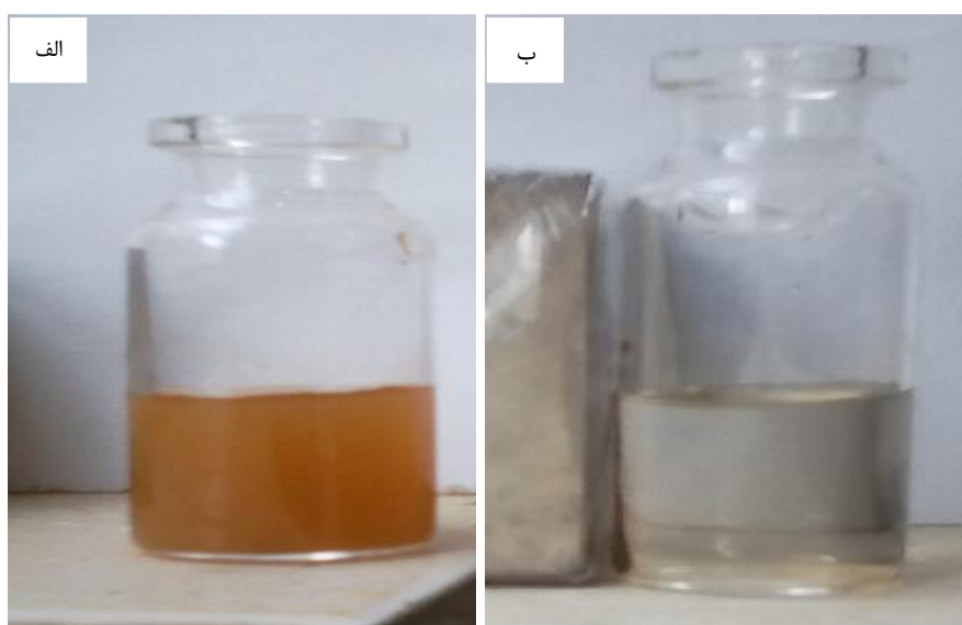
شکل (۳-۴۷) جدا شدن ذرات جاذب از درون محلول پس از عمل جذب، با استفاده از یک آهنربا.
