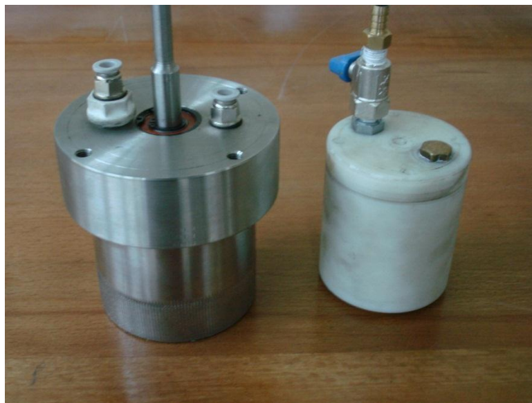
شکل ۳-۴- تصویر قندانی فولادی و تفلونی ساخته شده برای آسیاب پروانه ای
