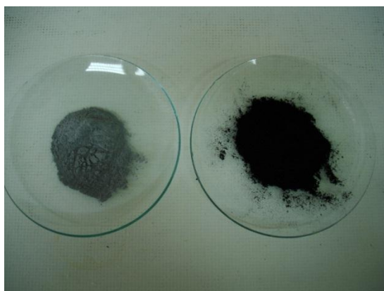
شکل ۳-۶- تصویری از پودر کامپوزیتی Al/SiC که بعد از آسیاب کاری سوخته است. نمونه سمت راست مربوط به بعد از آسیاب کاری و نمونه سمت چپ مربوط به قبل از آسیاب کاری می‌باشد.
