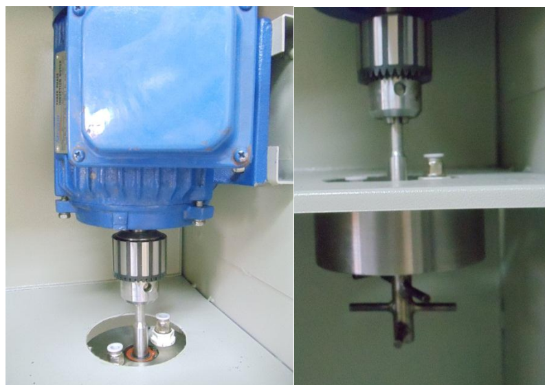
شکل ۳-۲- تصاویر اتصال موتور و پروانه‌های آسیاب پروانه ای
