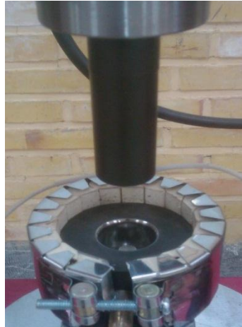
شکل ۴-۱۲- تصویری از قالب پرس که برای پرس نمونه‌ها استفاده شده است.
