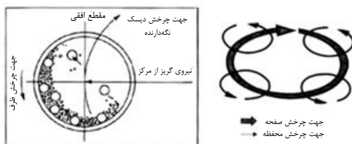
شکل ۳-۵- طرح شماتیک عملکرد و نحوه حرکت اجزای آسیاب سیاره‌ای
