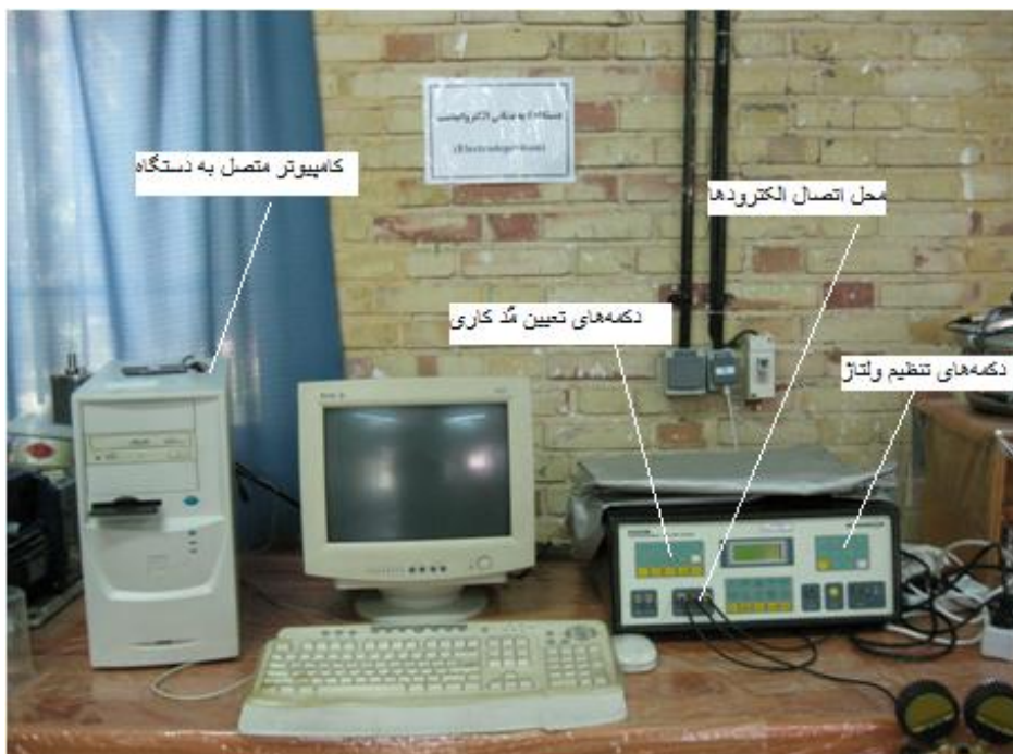
شکل ۲-۵- تصویر از دستگاه آنالیز الکتروشیمیایی استفاده شده (Behpajoo-BHP2063) در این تحقیق جهت اندازه‌گیری جریان-ولتاژ در نمونه‌ها.
