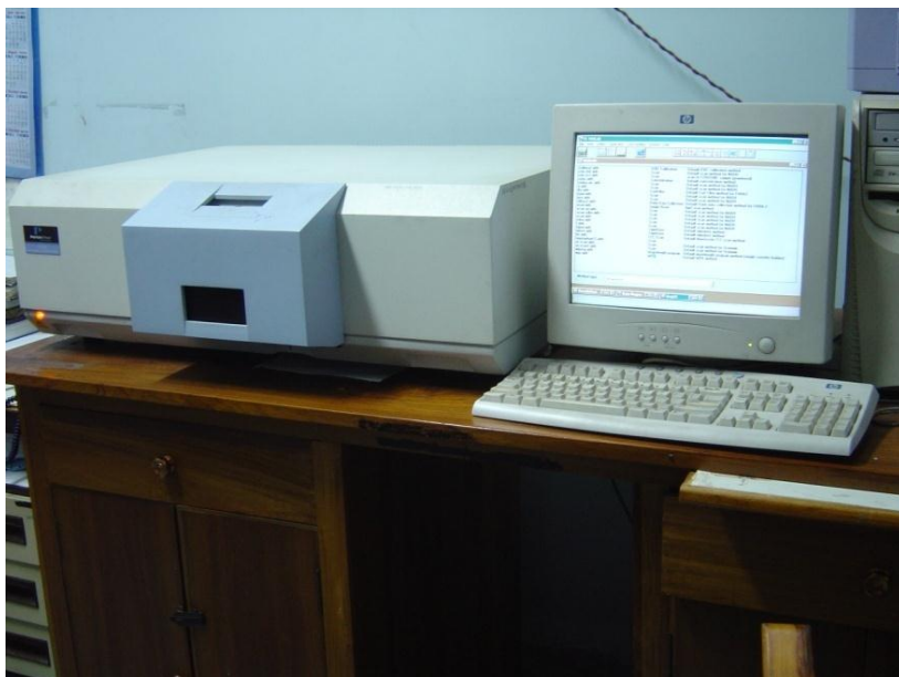
شکل ۲-۴) - نمایش از دستگاه فوتولومینسانس (Perkin Elmer LS-55 Luminescence Spectrometer) بکار گرفته شده در اندازه گیری خواص اپتیکی نمونه‌ها در دانشگاه تهران.
