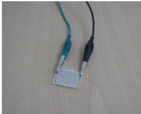
شکل ۵-۹ تصویر قطعه الکترولومینسانس ساخته شده به کمک فیلم نازک سولفیدروی آرایش یافته با منگنز
