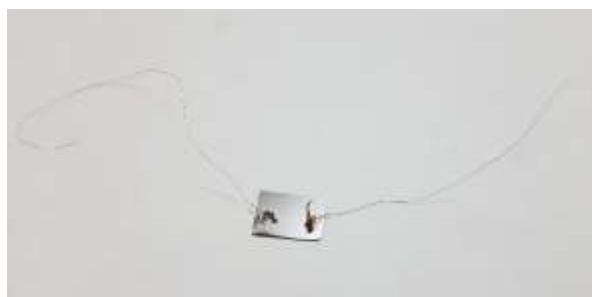
شکل (۹-۵) نمونه لایه نشانی شده اکسید قلع روی زیرلایه سیلیکون به روش CVD که با چسب نقره الکتروودگذاری شده و سیم های مسی به آن متصل شده اند.
