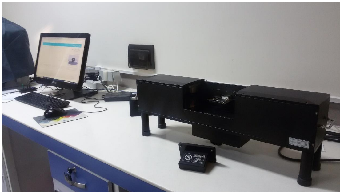
شکل ۷-۲ دستگاه بکار گرفته شده برای اندازه گیری اثر هال را نشان می دهد.
