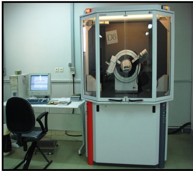
شکل ۲-۲: دستگاه پراش پرتو X مدل Bruker-AAXS در دانشگاه دامغان.
