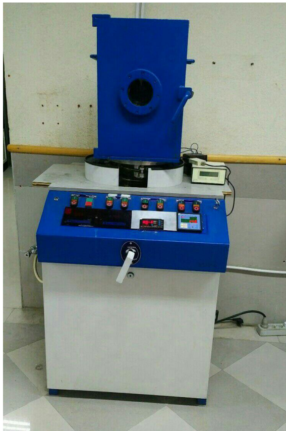
شکل ۸.۳: دستگاه لایه نشانی تبخیر حرارتی استفاده شده در این تحقیق
