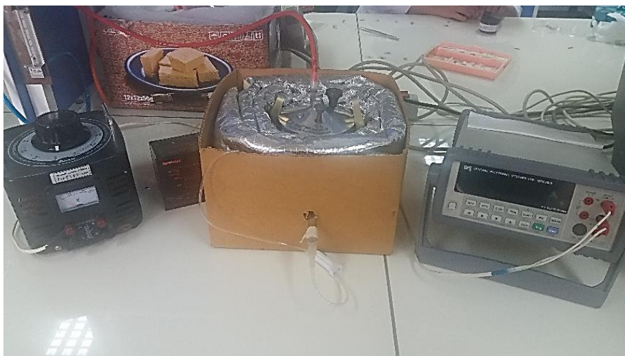
شکل ۸-۳ : دستگاه دست ساز حسگری گازی دانشگاه صنعتی شاهرود استفاده شده در این پایان نامه
