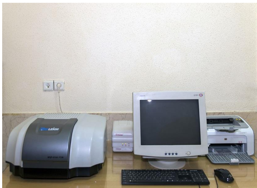
شکل ۳-۴ : دستگاه تبدیل فوریه مادون قرمز FTIR مدل Rayleigh کشور چین مورد استفاده در این پایان نامه
