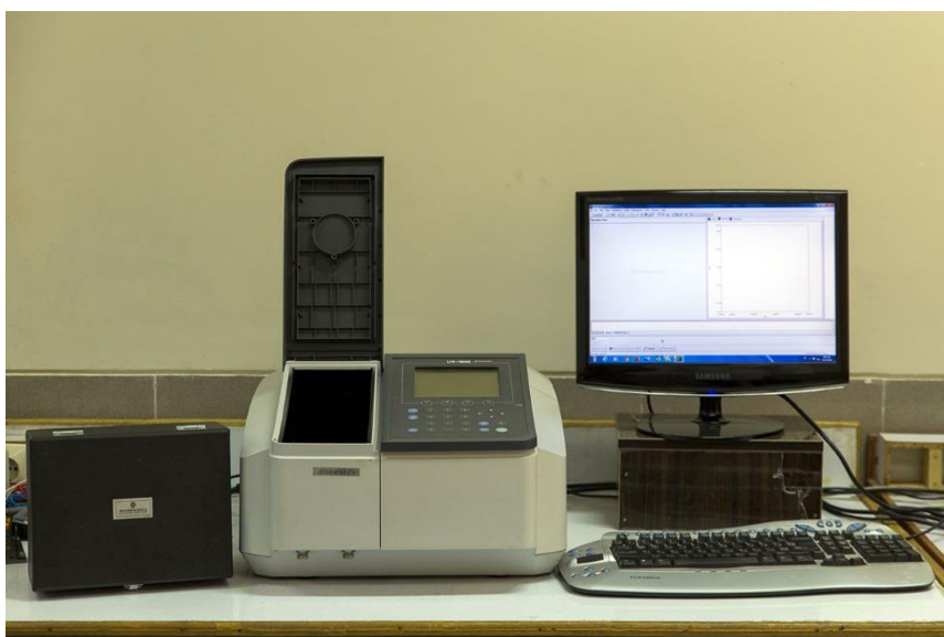
شکل ۳-۴: دستگاه مدل Shimadzu uv- vis.1800 استفاده شده در این پایان
