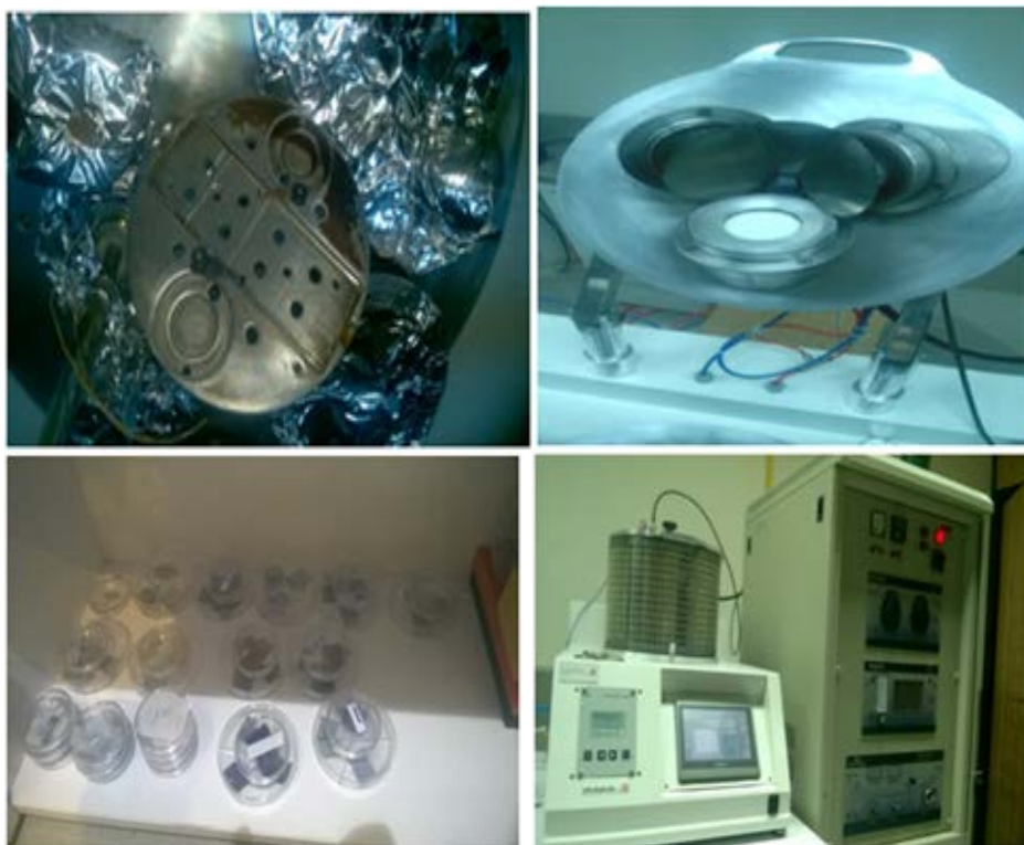
شکل ۴-۱ آماده‌سازی و چینش زیرلایه‌ها برای لایه‌نشانی با دستگاه اسپاترینگ دانشگاه صنعتی شاهرود با دو تارگت اکسید روی و نقره به همراه نمونه‌های لایه‌نشانی شده
