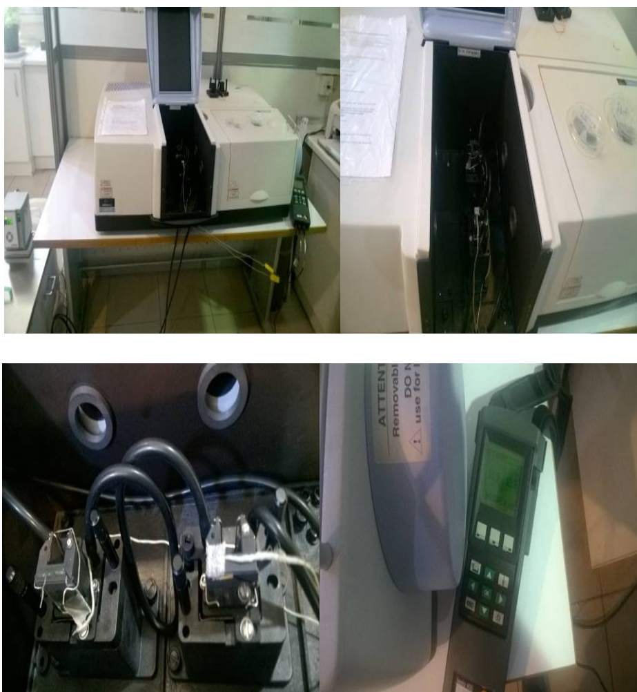
شکل ۴-۱۷ اسپکتروفوتومتر به همراه سیرکولاتور و ترموکوپل‌های نصب شده برای اندازه‌گیری دمای سطوح نمونه‌ها برای آزمون در دماهای مختلف
