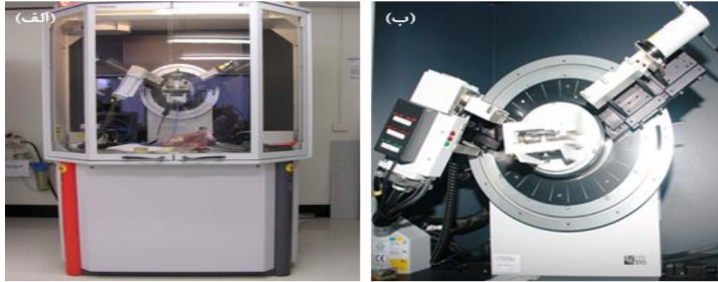
شکل ۸-۲: (الف) تصویری از دستگاه پراش پرتوی X مدل Bruker – AX در دانشگاه دامغان، (ب) محل قرارگرفتن نمونه.
