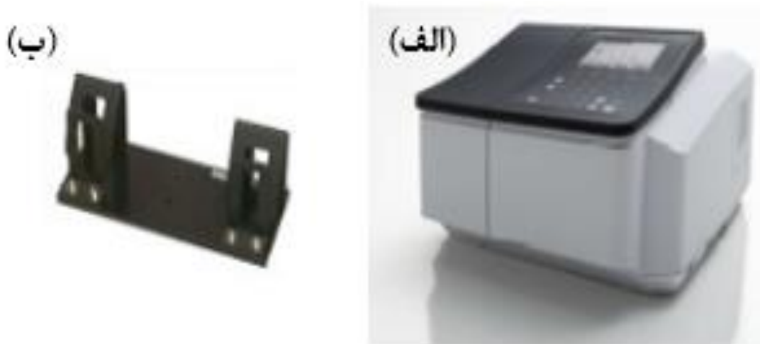
شکل ۲-۳: (الف) دستگاه طیف سنج نوری مدل (Shimadzu UV-Vis , ۱۸۰۰) مستقر در دانشکده فیزیک دانشگاه صنعتی شاهرود ، (ب) جایگاه های قرارگیری نمونه های مرجع و شاهد برای تعیین درصد عبور.
