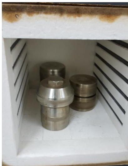
شکل ۳-۹ ظروف اتوکلاو قرار داده شده درون کوره در اشکال متفاوت حاوی محلول مواد اولیه،
