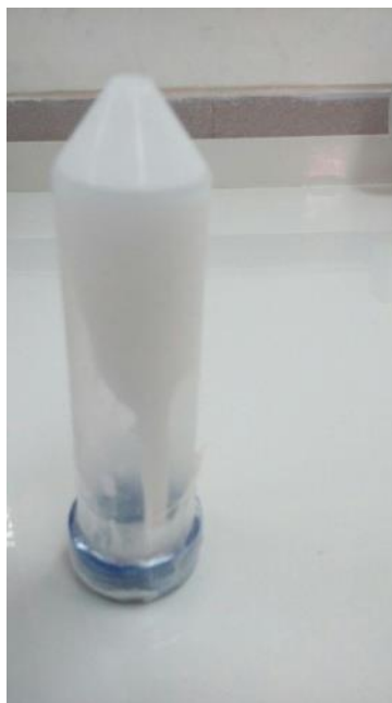
شکل ۴-۲ لوله آزمایش حاوی خمیر اکسید تیتانیوم که به صورت وارونه نگه داشته شده است.
