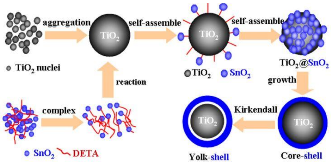
شکل ۱-۲ یک مدل احتمالی برای شکل گیری ساختار هسته-پوسته \text{TiO}_2@ \text{SnO}_2 [۳].
