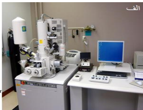
شکل ۱-۸: (الف) : دستگاه میکروسکوپ الکترونی روبشی گسیل میدانی (FESEM) مدل (S۳۶۰۰MV۳۰۰) دانشگاه تهران (ب) تصویر شماتیک از اجزای داخلی و مسیر عبور باریکه الکترونی تا سطح نمونه.
