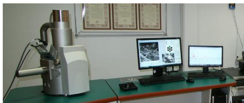
شکل ۱-۱۱: دستگاه SEM مدل VEGA/TESCAN-XMU مجهز به سیستم EDX.
