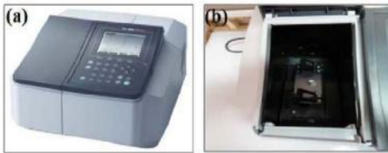
شکل ۱-۹: الف) طیف نگار مدل Shimadzu (UV-Vis, 1800) دانشگاه صنعتی شاهرود ب). جایگاه‌های قرارگیری نمونه‌های آزمایشی و شاهد برای تعیین ضرایب عبور و جذب.
