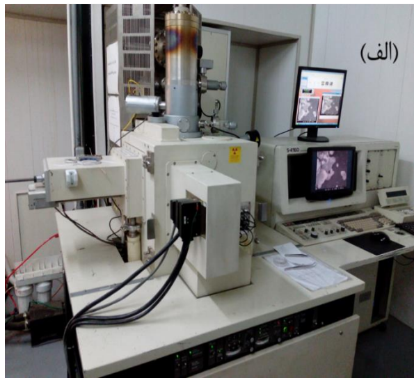
شکل ۲-۱۰: الف) میکروسکوپ الکترونی گسیل میدانی (FESEM) دانشگاه تهران، و ب) طرح‌واره‌ی ساختار داخلی میکروسکوپ الکترونی روبشی گسیل میدانی (FESEM).
