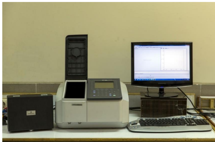
شکل ۲-۱۲: دستگاه طیف سنج نوری مدل (Shimadzu UV-Vis. 1800) واقع در دانشگاه صنعتی شاهرود.
