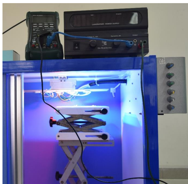
شکل ۲-۸: مجموعه‌ی استفاده شده جهت اندازه‌گیری جریان نوری بر حسب زمان.
