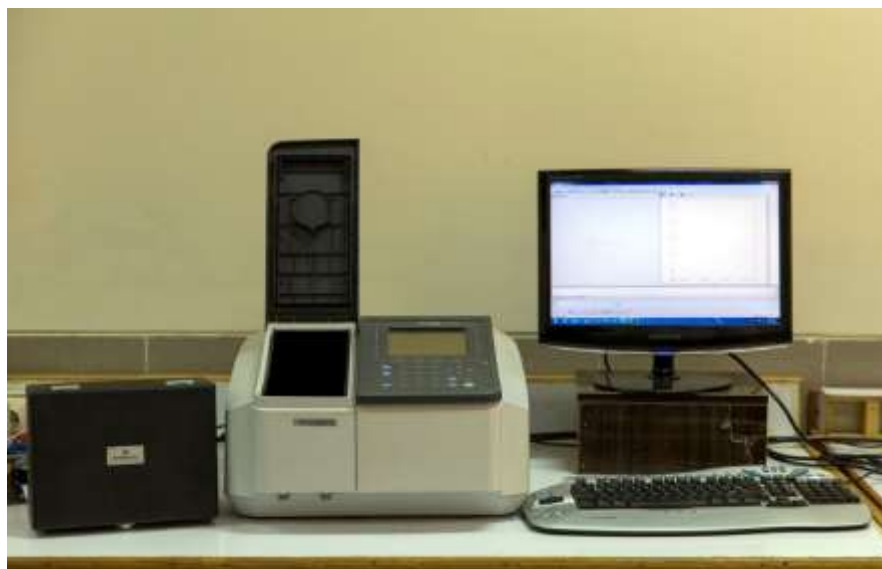
شکل ۸-۲: تصویری از دستگاه اسپکتروفوتومتر مدل Shimadzu - 1800، در دانشگاه صنعتی شاهرود جهت مشخصه‌یابی اپتیکی نمونه‌ها
