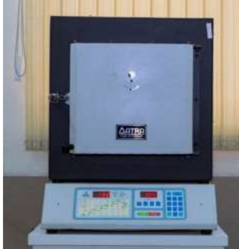
شکل ۲-۳: تصویر کوره ی باکس 1200^{\circ}\text{C} درجه در دانشگاه صنعتی شاهرود، برای بازپخت نمونه‌ها
