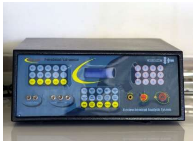
شکل ۶-۲: تصویری از دستگاه آنالیز الکتروشیمیایی مدل PGS 2065، در دانشگاه صنعتی شاهرود جهت بررسی رسانندگی سطحی نمونه ها
