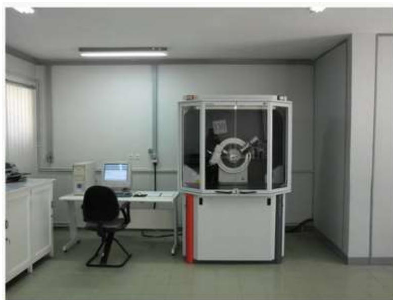
شکل ۲-۲: تصویر دستگاه پراش اشعه ایکس مدل D8-Advance Bruker در دانشگاه دامغان
