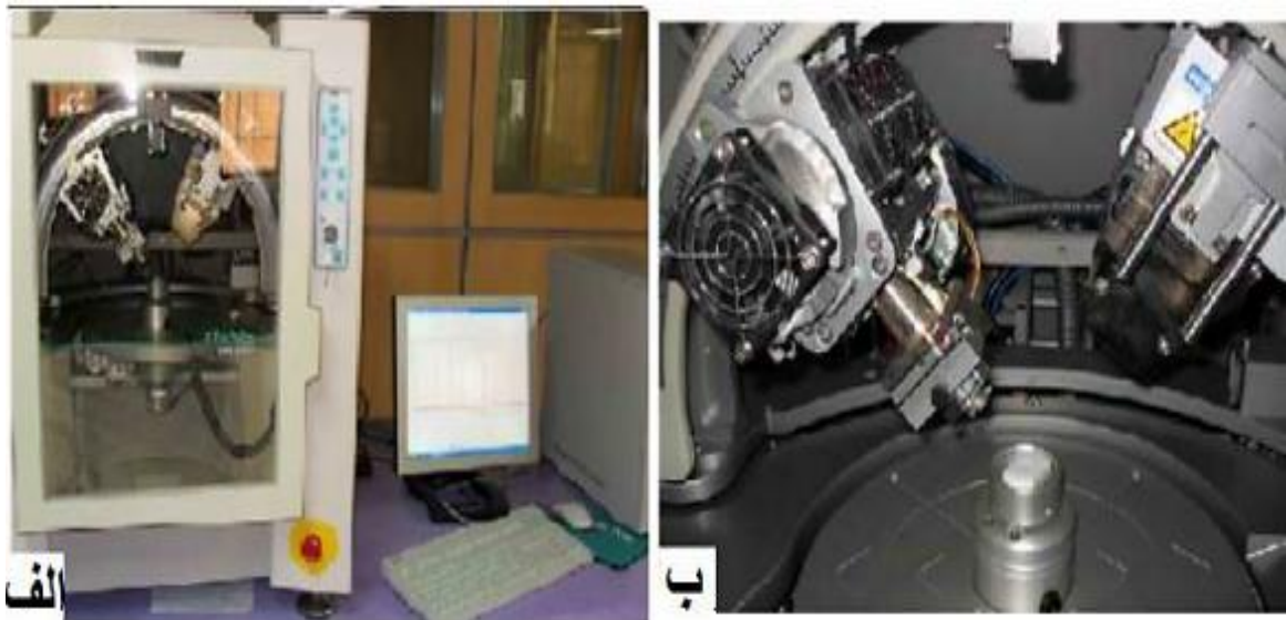
شکل ۲-۳: (الف) تصویری از دستگاه پراش پرتو ایکس مدل (Uniscence S300) موجود در دانشگاه صنعتی شاهرود. (ب) محل قرار گرفتن نمونه‌ها.
