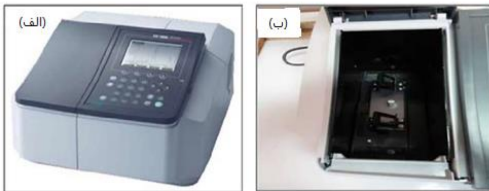
شکل ۲-۶: (الف) دستگاه بیناب سنج (Shimadzu (UV-1800 مستقر در دانشگاه صنعتی شاهرود (ب) جایگاه‌های قرارگیری نمونه‌های مرجع و شاهد.
