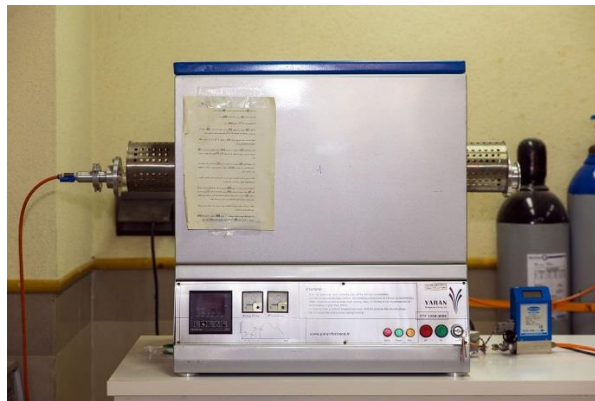
شکل ۳-۳: کوره تیوپی با مدل (YTF 1250-30X8) واقع در دانشگاه صنعتی شاهرود.
