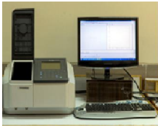
شکل ۶-۲: دستگاه طیف سنجی مرئی - فرابنفش واقع در دانشگاه صنعتی شاهرود.
