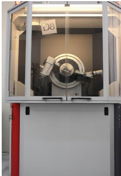
شکل ۲-۲: دستگاه پراش پرتو X مورد استفاده جهت بررسی ساختاری لایه‌ها واقع در دانشگاه دامغان.
