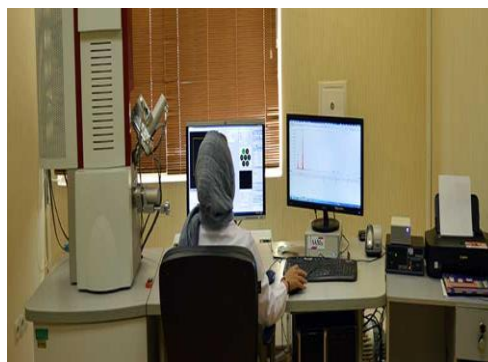
شکل ۲-۵: دستگاه SEM مدل VEGA\\TESCAN-XMU مجهز به سیستم EDX.
