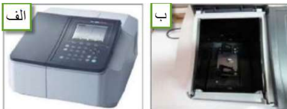
شکل ۳-۴: (الف) دستگاه اسپکتروفوتومتر مدل Shimadzu (UV -Vis, 1800) مسقر در آزمایشگاه نانو فیزیک دانشگاه صنعتی شاهرود (ب). جایگاه های قرارگیری نمونه های آزمایشی و مرجع برای تعیین ضرایب عبوری و جذبی.
