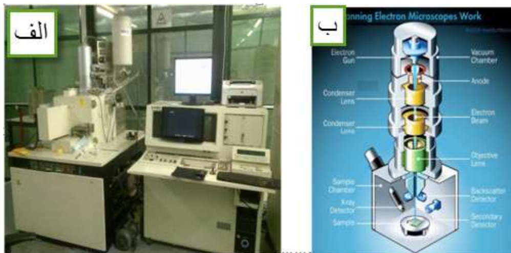
شکل ۳-۱: (الف) نمایی از میکروسکوپ الکترونی روبشی اثر میدانی (FESEM, Hitachi S-4160) بکار گرفته شده در دانشگاه تهران. (ب) تصویر شماتیک از اجزای داخلی مسیر عبور باریکه تا سطح نمونه.
