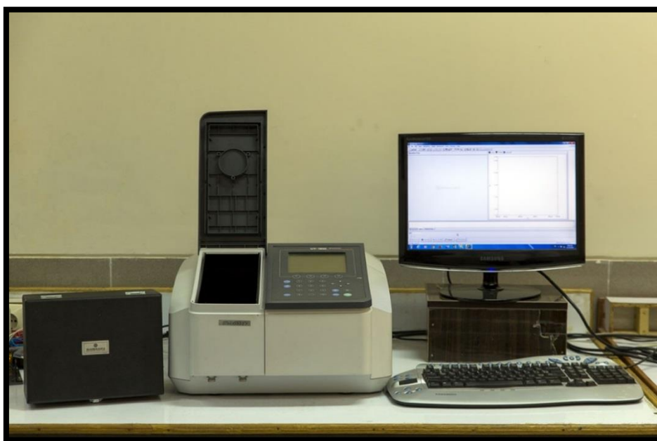
شکل ۴-۲ دستگاه طیف سنج نوری مدل (Shimadzu UV-Vis. 1800) واقع در دانشگاه صنعتی شاهرود.
