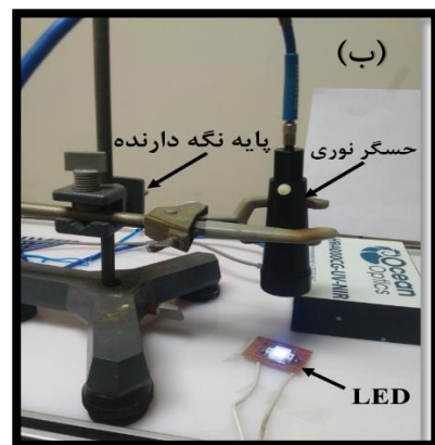
شکل ۲-۹ (الف) طیف‌های نوری LED های آبی و قرمز استفاده شده برای بررسی اثر فوتورسانایی در نمونه‌های سنتز شده در فصل ۴، (ب) تصویری از دستگاه طیف نگار نوری واقع در دانشگاه صنعتی شاهرود.
