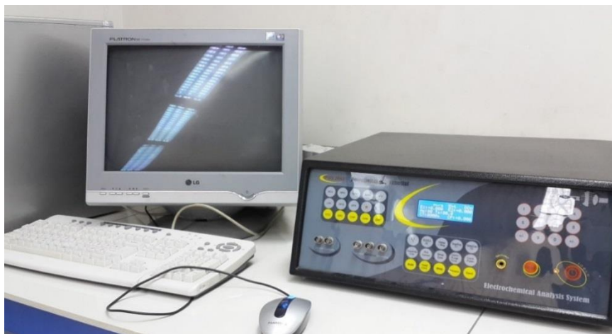
شکل ۶-۲ دستگاه پتانسیومتر آنالیز الکتروشیمیایی PGS 2065 واقع در دانشگاه صنعتی شاهرود.
