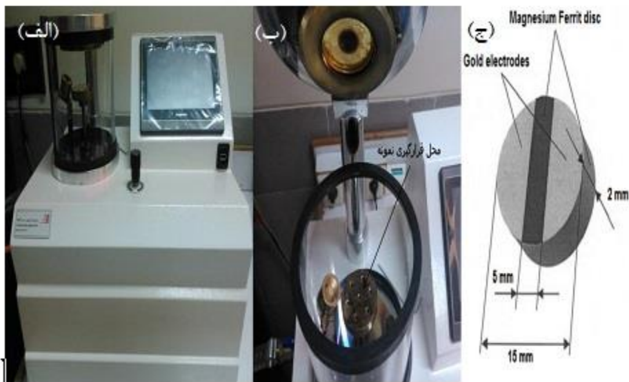
شکل ۳-۸: الف) نمونه‌ای از یک دستگاه کندوپاش موجود در دانشگاه صنعتی شاهرود (ب) محل قرارگیری نمونه (ج) پهنای الکتروود.
