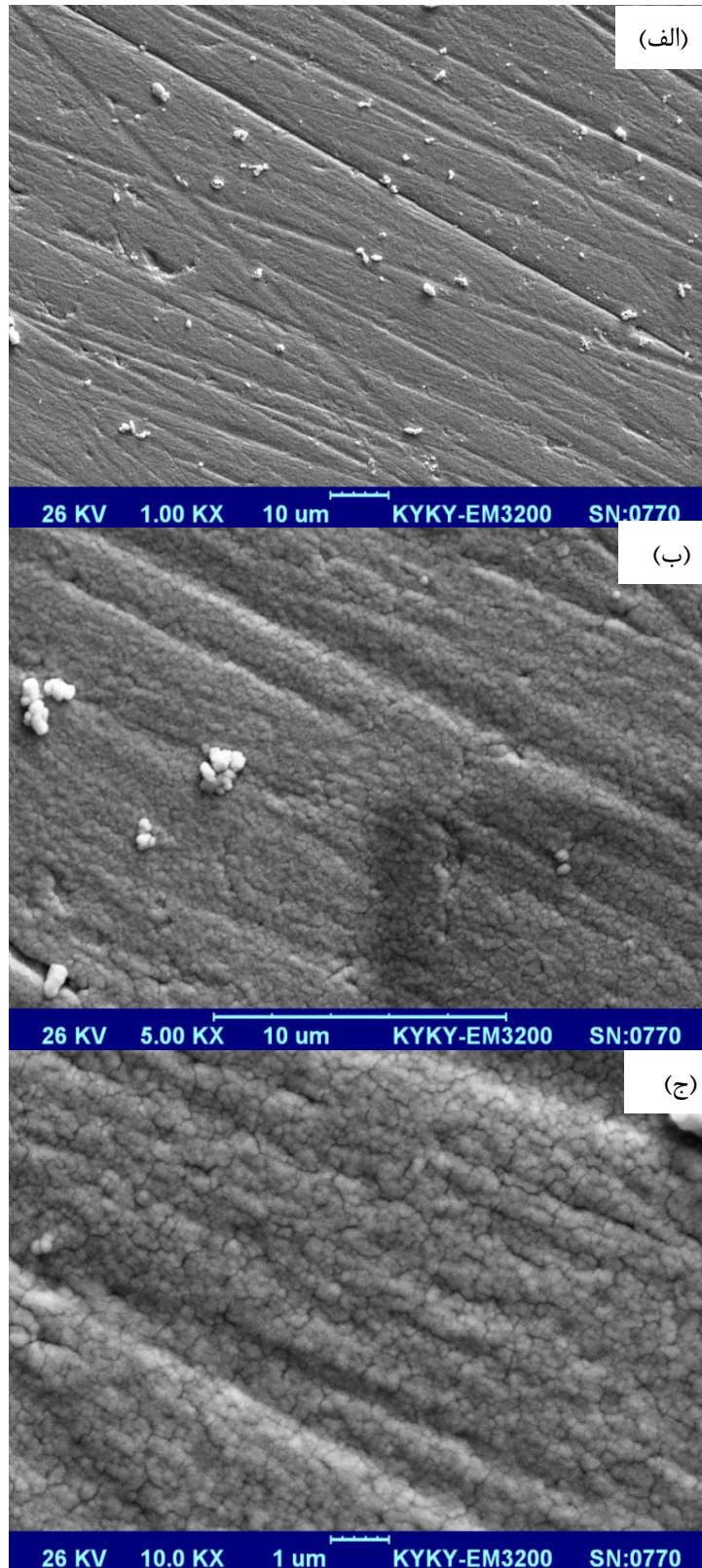
شکل ۵-۱۰: عکس‌های نمونه‌ی کد GH15، نمونه‌ی تابش دیده با چشمه‌ی مسطح در دمای 100^{\circ}\text{C} ،
