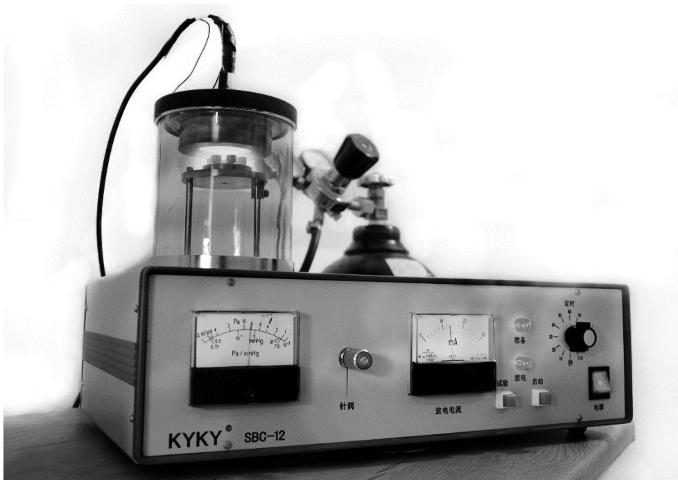
شکل ۲-۵: نمایی از دستگاه لایه‌نشانی استفاده شده
