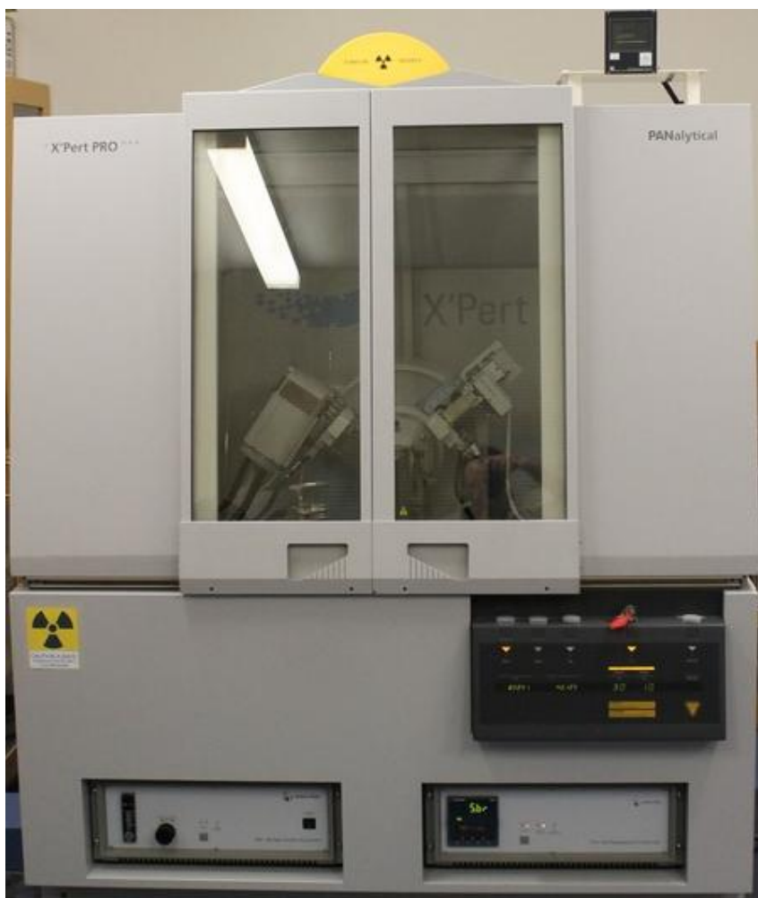
شکل ۱-۲: دستگاه پراش پرتو ایکس مورد استفاده در موسسه کفا.
