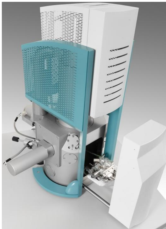
شکل ۲-۳ دستگاه میکروسکوپ الکترونی روبشی مدل Mira 3-XMU مورد استفاده در این تحقیق.
