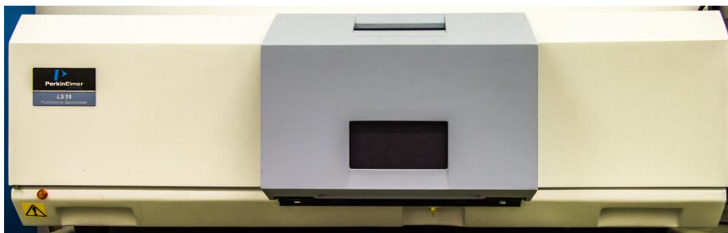
شکل ۲-۴ دستگاه طیف سنج فوتولومینسانس مدل LS55 شرکت Perkin-Elmer مورد استفاده در این تحقیق.
