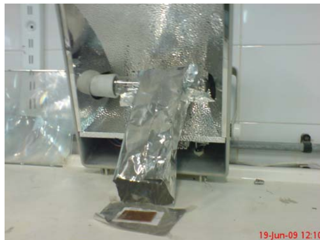
شکل (۵-۱۴): شبیه ساز خورشیدی ساخته شده از لامپ Metal Halide
