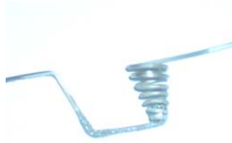
شکل (۵-۱۱): نمونه ای از بوته سبیدی (تنگستنی) ساخته شده
