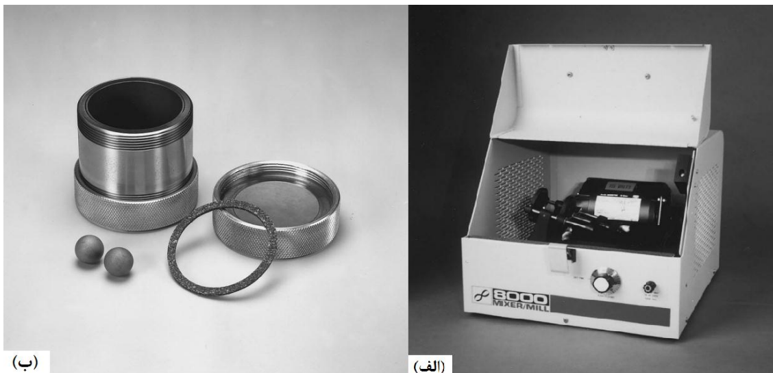
شکل (۱-۳) الف) آسیای لرزشی SPEX ب) قندانی با جنس کاربید تنگستن، در قندانی، واشر و گلوله [۵۸]
