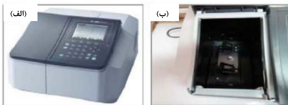
شکل ۴-۲: الف) دستگاه اسپکتروفوتومتر (Shimadzu UV-1800) در دانشگاه شاهرود (ب) جایگاه‌های قرار گیری نمونه‌های شاهد مرجع.
