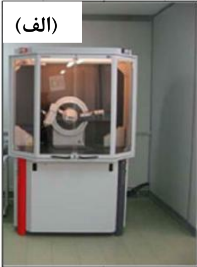
شکل ۲-۲: (الف) دور نمایی از دستگاه پراش پرتو X مدل Bruker-AAXS در دانشگاه دامغان (ب) محل قرار گرفتن نمونه.
