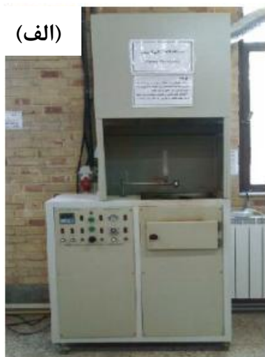
شکل ۳-۲: (الف) دستگاه اسپری پایرولیز استفاده شده در این تحقیق S. C. S. 86 در Spary Coating System. دانشگاه شاهرود و (ب) طرح شماتیک از دستگاه اسپری [۲۸].
