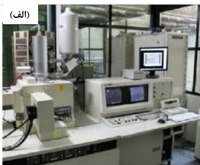
شکل ۱-۲: (الف) نمایی از میکروسکوپ الکترونی روبشی گسیل میدانی (FESEM) بکار گرفته شده در مورفولوژی سطح نمونه در دانشگاه تهران و (ب) تصویر شماتیک از اجزای داخلی مسیر عبور باریکه الکترونی تا سطح نمونه [۲۰].
